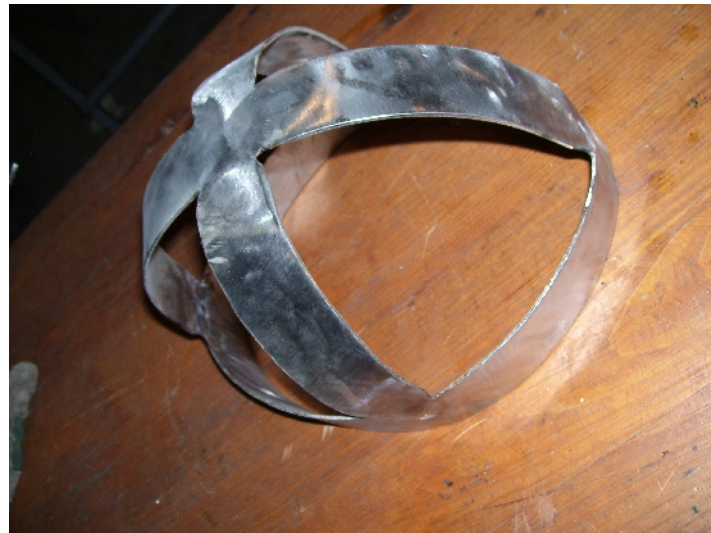
Abbildung 10: Vorher: nach dem Abschleifen der Schweißnähte wird das Konstrukt noch einmal auf seine Festigkeit geprüft und komplett abgeschleift, was ihm eine unschön glitzernde Oberfläche verleiht
