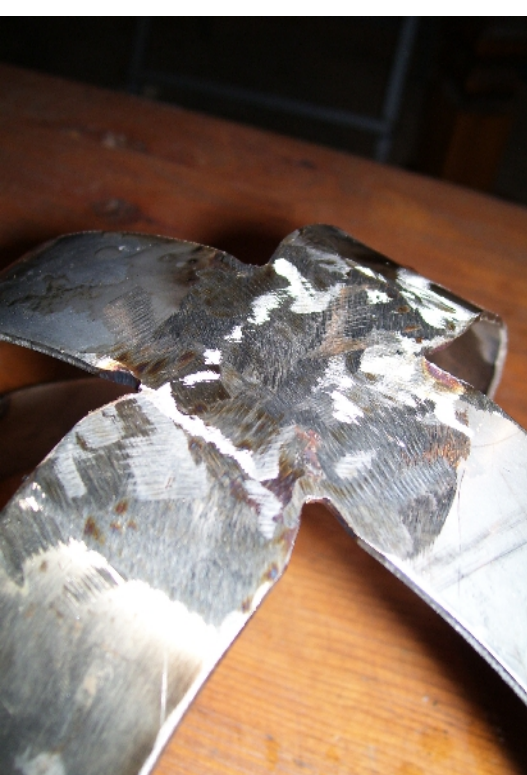
Abbildung 9: Nach dem Abschleifen: die Schweißnähte auf der Außenseite sind weg, dafür sind die Schleifstellen alles andere als ansehnlich
