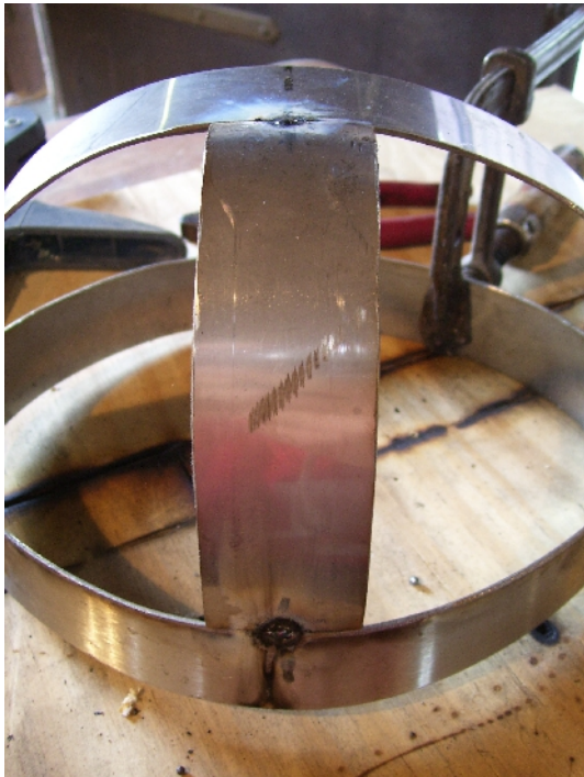
Abbildung 6: Noch einmal: um Fehler zu vermeiden die beim vollen Verschweißen nicht mehr oder nur schwer zu korrigieren sind, verschweiße ich erst einmal nur punktuell um danach erneut auszumessen.
