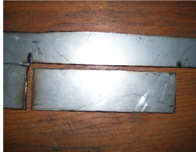
Abbildung 2: Das 2mm dicke Stahlblech beim Zuschneiden der einzelnen Streifen, die später zum Metallhelm vereint werden.
