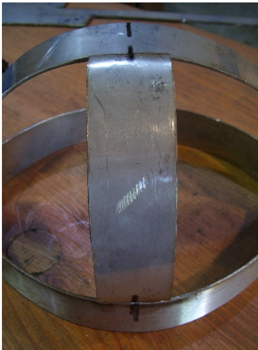
Abbildung 5: Um möglichst genau zu arbeiten, und unschöne Verschiebungen zu vermeiden die später nicht mehr zu korrigieren sind, wird noch einmal genau ausgemessen und schließlich markiert wo die Teile verschweißt werden sollen.
