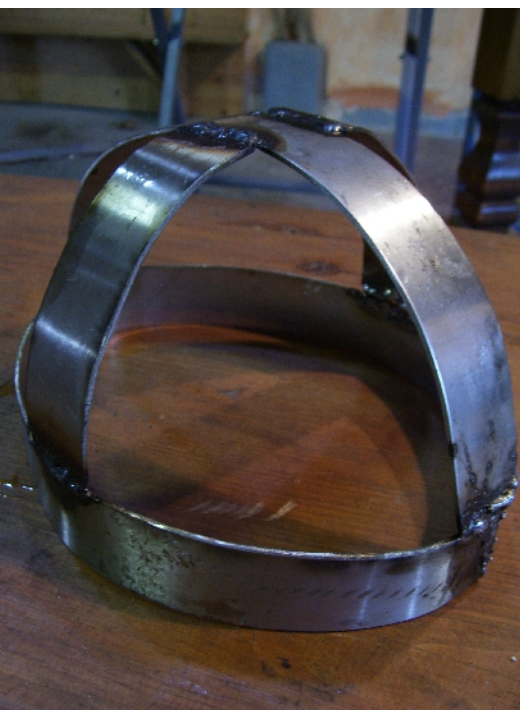
Abbildung 8: Die Schweißnähte auf der äußeren Seite sehen nicht gerade schön aus, und sollten auf jeden Fall abgeschleift werden
