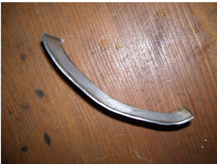
Abbildung 3: Einer der Metallstreifen (hier: Seitenstreifen) beim Biegen. Man sieht hierbei schön, dass es eben nicht so schön ist. Der Kopf ist halt nicht geometrisch perfekt.
