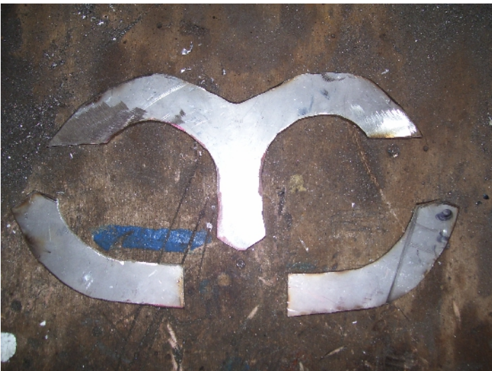
Abbildung 12: Die Einzelteile der Brille, die später miteinander verschweißt werden.
