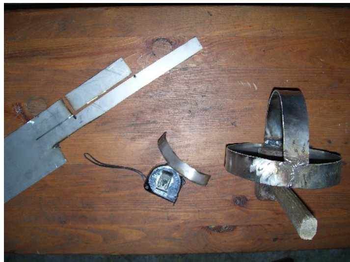
Abbildung 4: Die Schritte 3-5 vereint auf einem Bild: Zuschneiden, biegen, Schweißen
