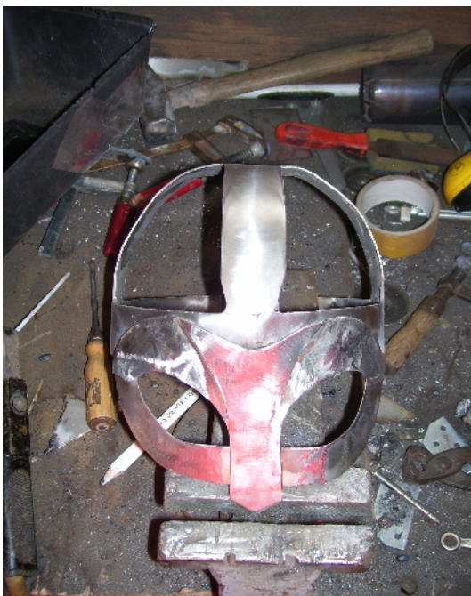
Abbildung 17: Nach dem Verschweißen: das metallene Grundgerüst ist (fast) fertig
