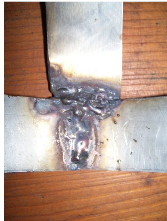
Abbildung 7: Die Schweißnähte auf der Innenseite: die Schlack ist noch nicht ganz abgeklopft, zudem sollte die Naht nachher noch mit ner Drahtbürste gesäubert werden
