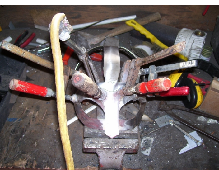
Abbildung 15: Vorbereitung des Verschweißens von Brille mit Helm
