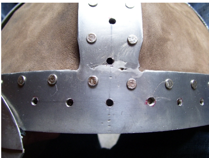
Abbildung 19: Die Bohrlöcher, am inneren Rand für's Leder, in der Mitte für die Messing-Applikationen. Deutlich sichtbar ist hier das matte Grau des Metalls nach dem 'Altern'.
